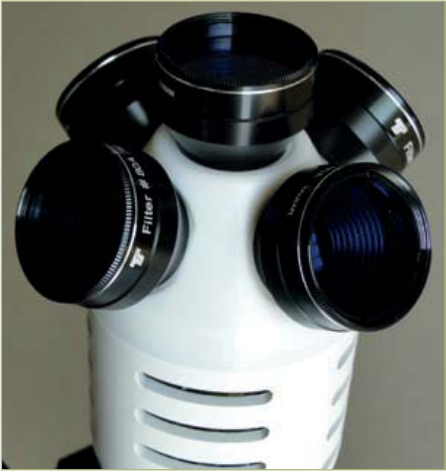
Bild 3. Konstruktion des Lichtmesskopfs mit den Blaufiltern.
