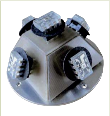
Bild 1. Die Lichtsensoren bilden zueinander feste Winkel.
