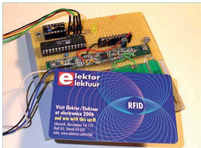
Bild 4. Musteraufbau mit ATmega88 und PN512-Readerplatine.
