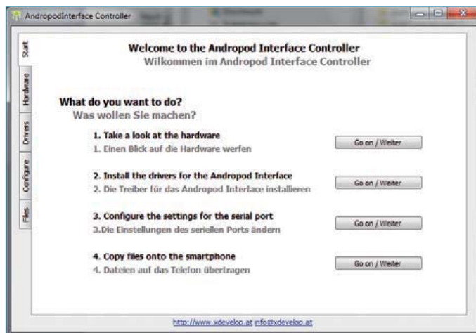
Bild 7. Die frei downloadbare PC-Software AdifController installiert Treiber, konfiguriert das Andropod und überträgt Dateien aufs Telefon.
